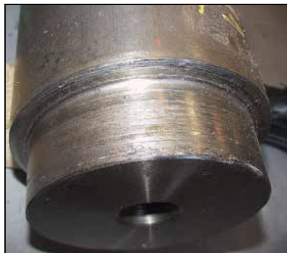
Gear fra en 300 kW-mølle, hvor man kan se skade på et leje og en lejepasning.
