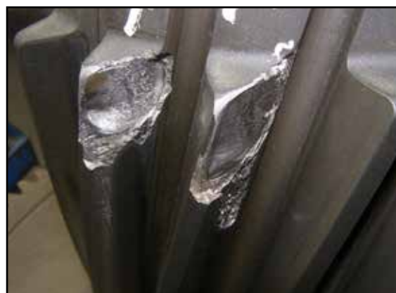
Gear fra en 1300 kW-mølle, hvor man kan se skader på flere af komponenterne i gearet.
